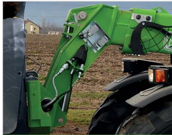
Tuberías, cables eléctricos y líneas hidráulicas auxiliares están colocados en el interior del brazo
